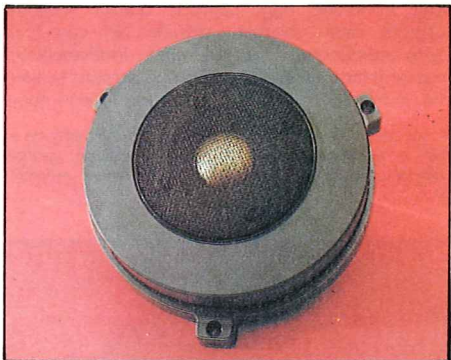
Il caratteristico altoparlante per i medio-acute, con complesso magnetico unico e midrange e tweeter montati in posizione ravvicinissima, a vantaggio dell'uniformità di emissione.
