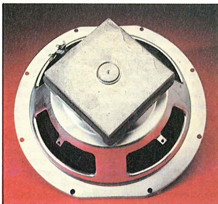
Il woofer da 30 cm è un altoparlante di classica scuola AR. Il caratteristico cestello è in lamiera stampata, la membrana è in impasto di cartone, il gruppo magnetico di forma quadrata. La bobina da 50 mm è avvolta su un supporto di alluminio forato (in alto).
